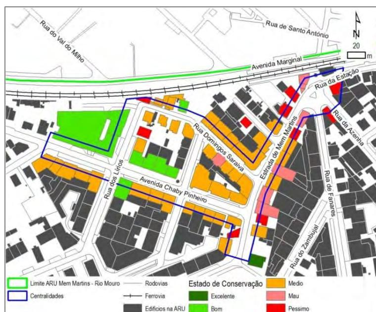
Figura 50 – Levantamento do Estado de Conservação do Edificado, abril 2015
