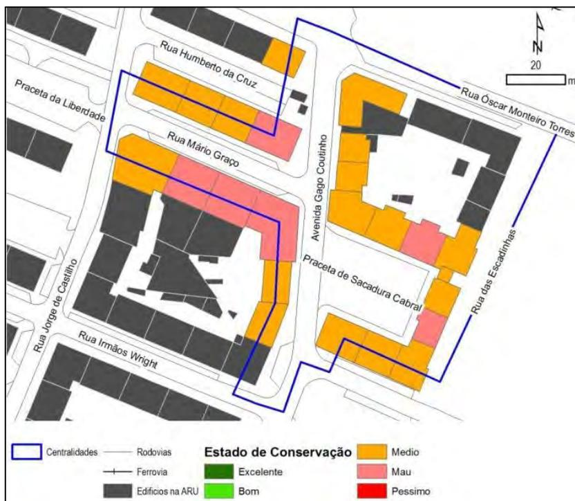
Figura 62 – Levantamento do Estado de Conservação do Edificado, abril 2015
